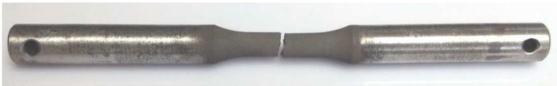
Hình 5.33. Mẫu phủ HVOF (60 \mu\text{m} ) gãy mỏi tại ứng suất \sigma = 475 MPa
