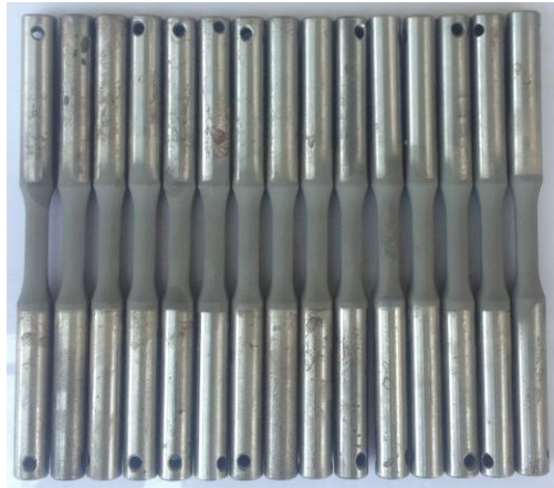
c) Mẫu sau khi phủ 60 \mu\text{m}
