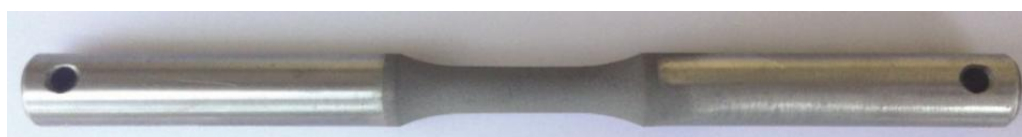
Hình 3.29. Chi tiết mẫu sau khi phủ HVOF
