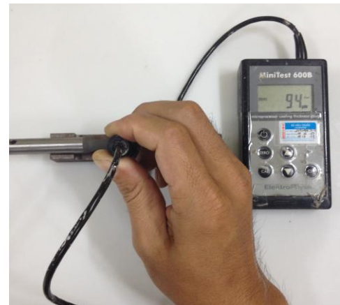
b) Đo chiều dày lớp phủ carbide
