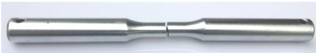
Hình 5.19. Mẫu gãy mỏi mạ crôm (60 \mu\text{m} ) tại ứng suất \sigma = 450 MPa
