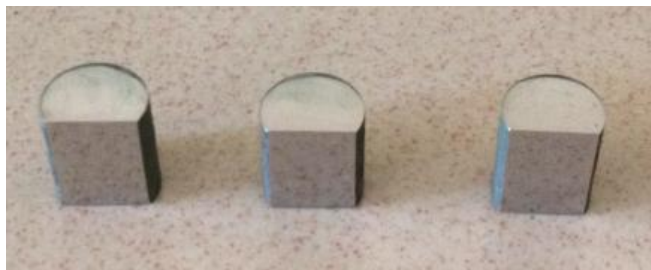
Hình 3.1. Mẫu kiểm tra thành phần vật liệu
