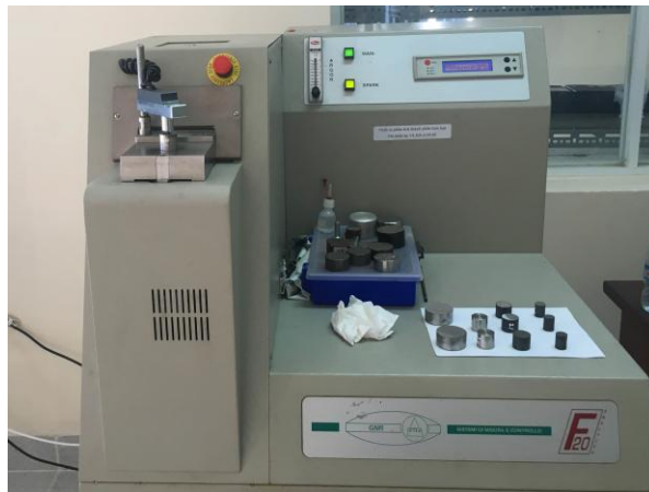
Hình 3.7. Máy quang phổ GNR-F20 (Italia)
