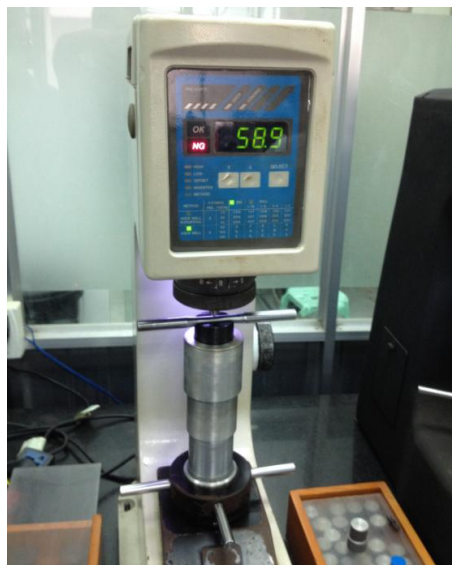
Hình 3.9. Đo độ cứng trên máy Mitutoyo ATK-600
