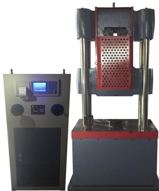
Hình 3.11. Thiết bị đo độ bền kéo WEW-1000B (Trung Quốc)
