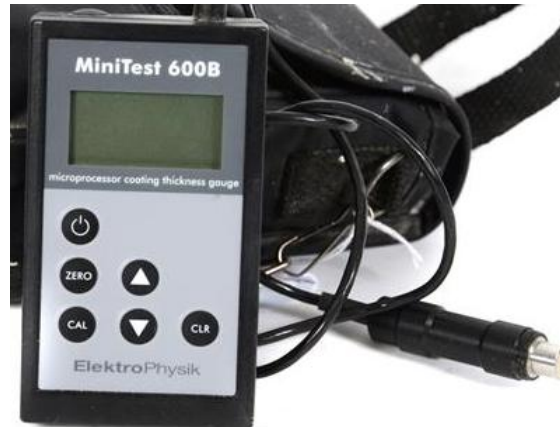
Hình 3.12. Thiết bị đo chiều dày lớp phủ MiNiTest 600B-Elektrophysik
