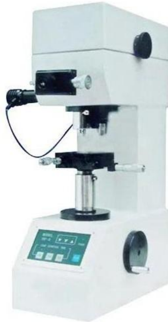
Hình 3.10. Đo độ cứng Vicker Meatall-HV5
